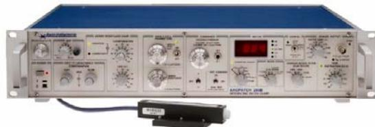
Axopatch200B 是目前世界上噪音最低的膜片钳放大器，它整合了电容反馈和单通道记录的探头冷却技术，特别适合小电导的单通道的记录，是最经典的膜片钳放大器。
