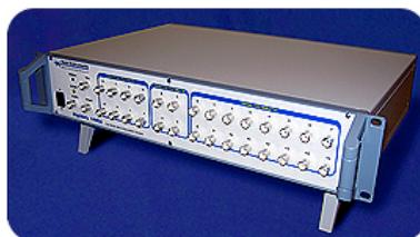
Digidata 1440A 是 MDC 公司新近推出的高分辨率、低噪声数模/模数转换器。它的功能是将膜片钳放大器所采集的电信号转换成数码信号，从而被计算机采样软件识别并记录；同时，它还将计算机软件输出的刺激信号转换成模拟信号输出给膜片钳放大器并最终施加给细胞。
